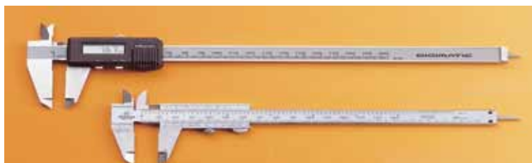
Pie de rey. Instrumento que permite medir una longitud en centímetros hasta la centésima.
